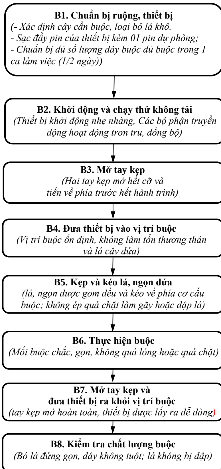
Hình 11. Sơ đồ quy trình buộc lá dứa bằng thiết bị cầm tay
